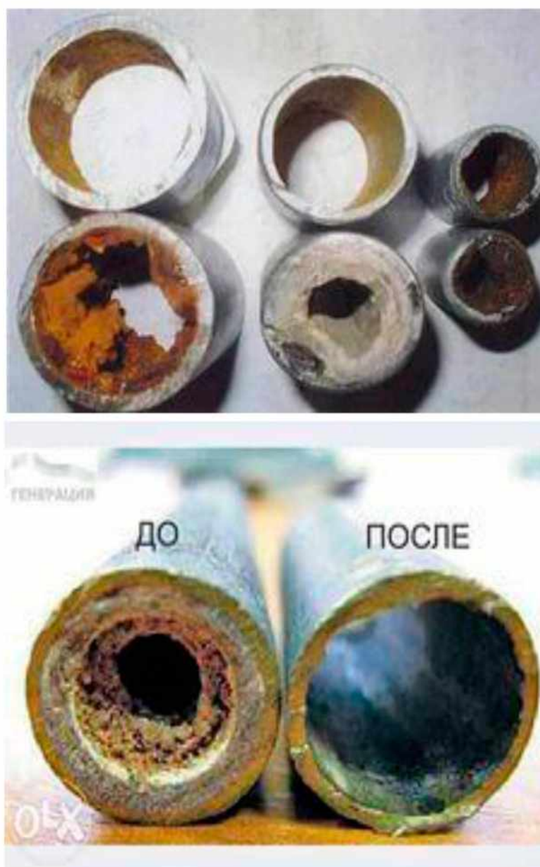
Рисунок 6.5 – эрозия, накипь и другие отложения (до и после промывки)
